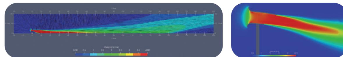
Simulations numériques des vitesses d'air des modèles V3b
